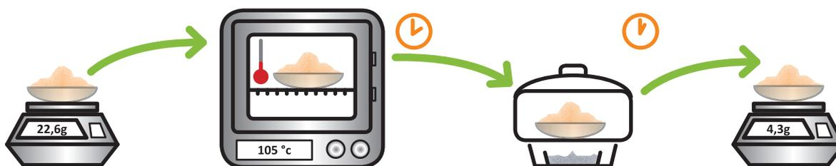
Figura 9 – Sequência de operações para determinação da humidade de um material.
