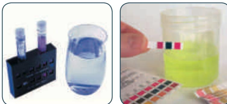
Figura 5 – Testes colorimétricos rápidos, em solução e em tiras.
